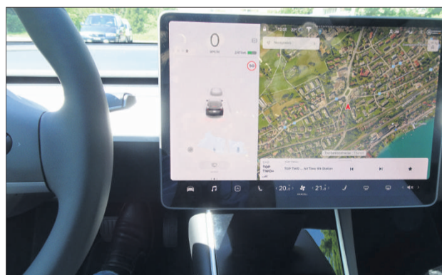
Touchscreen statt Armaturen, fast alles wird im Screen gesteuert.
