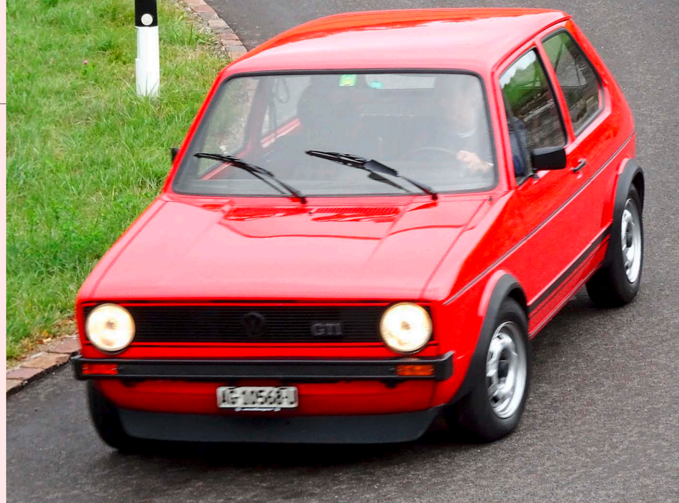
Erste Serie von 1976 bis 1978, erkennbar an der kleinen Stahl-Stoßstange.
