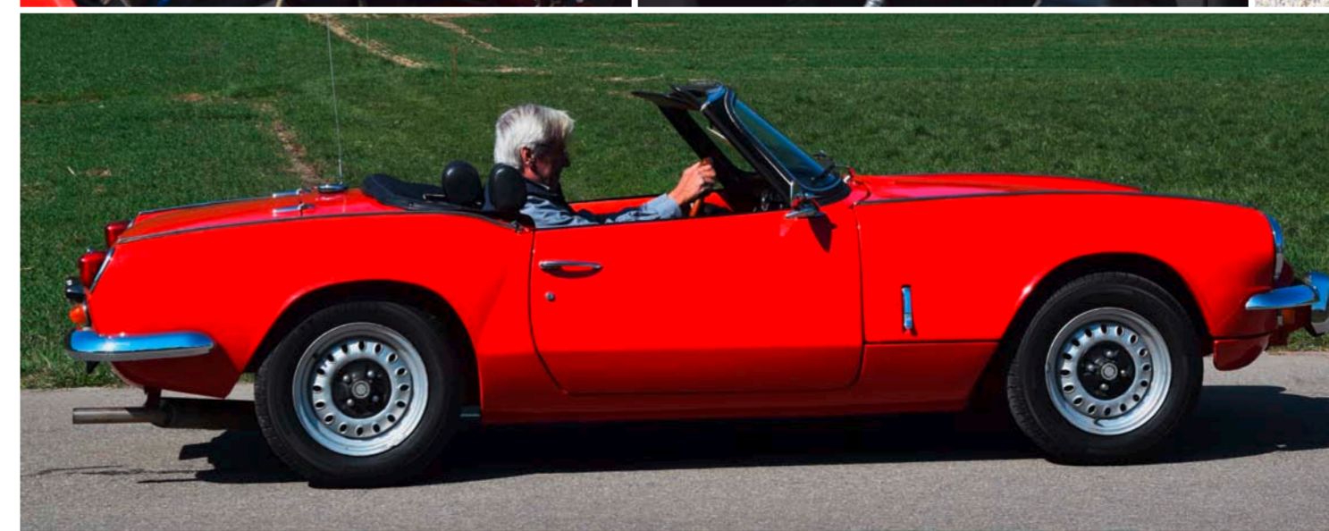
Spitfire Mk III Zwei SU-Vergaser, zum justieren frei zugänglich. Schöne Smith-Uhrensammlung mittig, passt für Rechts- und Linkslenker. Ordentlicher Kofferraum für eine Ferienfahrt zu zweit. (U.) Design von Giovanni Michelotti, sensationeller Einschlag, Wendekreis 7.3 m.
