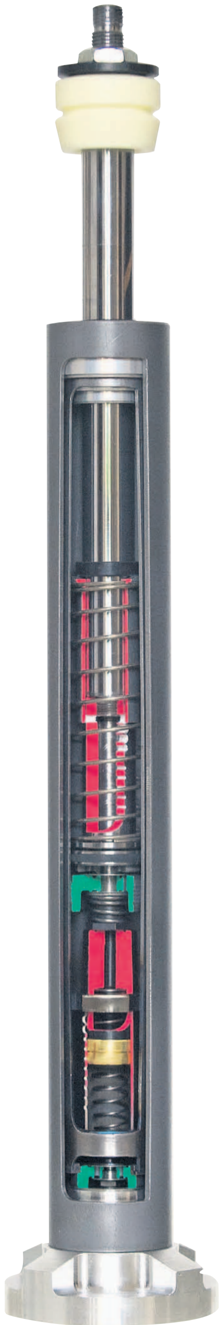
In den Stossdämpfern sind hydraulische Anschläge integriert.
