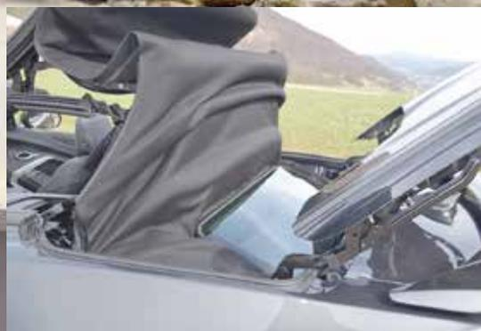
Oben und unten: Das Dach öffnet blitzartig, Mechanismus funktioniert bis 50 km/h.
