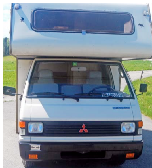
Aerodynamik war nicht; Chassis 1.7 m breit, der Aufbau ragt beidseitig 20 cm darüber hinaus.
