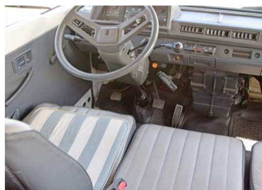
Frontlenker-Ambiente mit Lenkradschaltung, unter dem mittleren Sitz schuffet der Motor.
