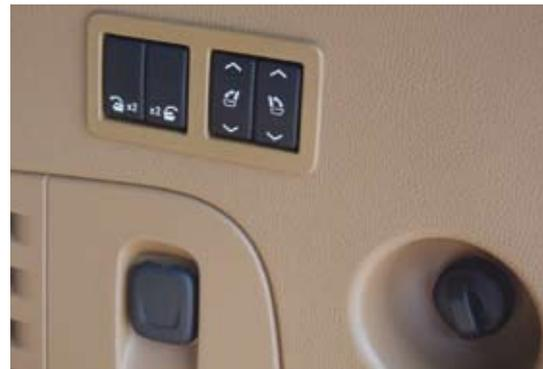
Oben: aufklappen, abklappen, alles elektrisch. Unten: automatisch ausfahrende Trittbretter.
