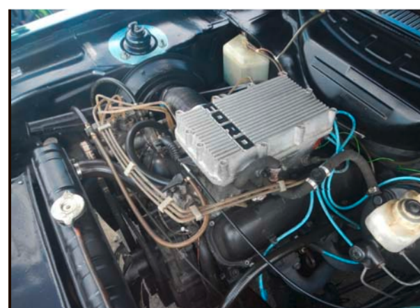
Stark und trinksüchtig 2.6-Liter-V6 im Capri RS 1971 mit Kugelfischer-Einspritzung.
