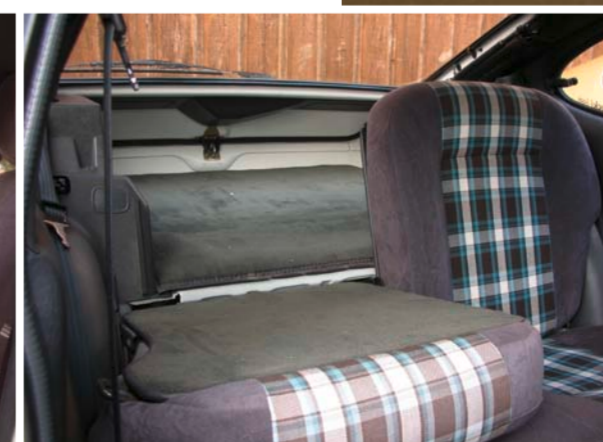
Erhöhter Nutzwert im Capri II und III mit klappbaren Einzelsitzen hinten.
