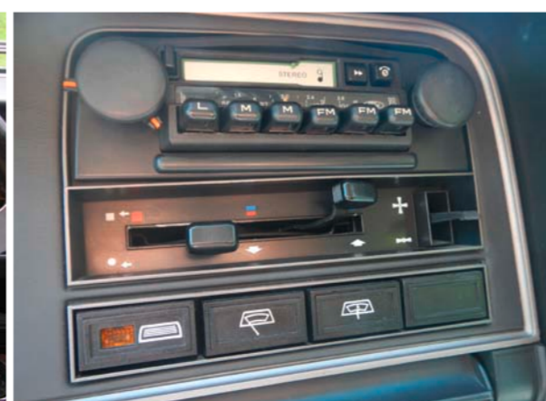
Simpel, aber effizient Radio-Kassetten-Gerät und zwei Schieberegler für die Heizung.
